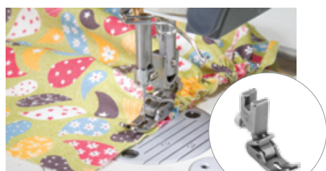
TEXI 5010 Stopka do marszczenia, regulowana
